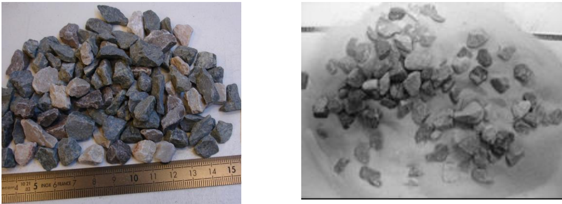
Figure 2. (a) Inclusions typiques utilisées ; (b) Mélange sable-inclusions avant humidification
